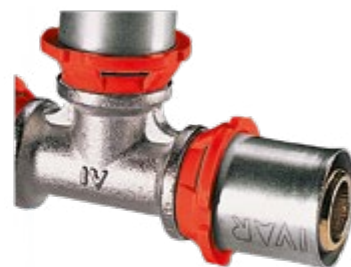
Fixační kroužek s průhledítkem (červený): bezpečné a těsné spojení s optickou kontrolou polohy trubky
